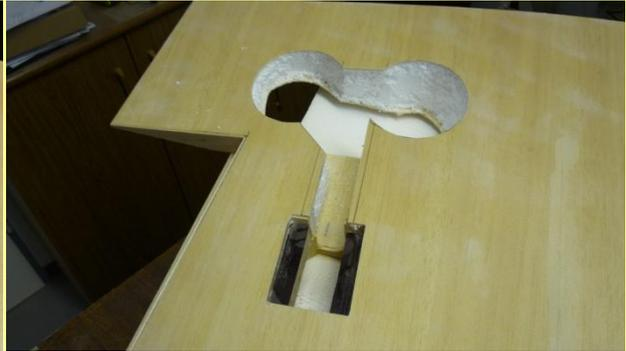
Nun kleben wir die Tragflächenmittelteile zusammen, zuvor wird die V-Form mit 7° zurecht geschliffen. Mit PU-Kleber kleben wir die Tragflächeninnenteile zu einem Mittelteil zusammen. Der Stoss wird mit Glasfasergewebe und Harz verstärkt.
