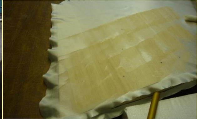
Nach 24 Stunden wird das überstehende Gewebe mit einem scharfen Messer an den Flächenkanten abgeschnitten. Danach werden die Landeklappen sowie die Querruder auf den Flügeln aufgezeichnet. Mit der Bandsäge und einem scharfen Messer werden diese aus der Tragfläche herausgeschnitten. Achtung! Beim Ausschneiden auf den 90°-Winkel achten.
