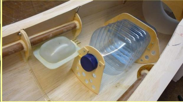
Die Triebwerksgondeln werden der Form des Tragflächenprofils angepasst. Schon beim Bau des Flächen-Mittelteils wurde Hartholz mit eingearbeitet, an dieses werden die Gondeln mit je zwei Schrauben befestigt.
