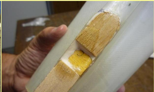
Auf diese Bauphase freuen wir uns schon seit langer Zeit. Es werden die Rumpfspitze und das Heck an die Rumpfröhre geklebt. Dazu nehmen wir unseren bewährten PU-Kleber. Nachdem die Spitze ausgerichtet und das Heck korrekt eingemessen ist, wird mit Klebeband die Spitze und das Heck gegen Verrutschen gesichert. Das Klebeband verhindert auch das Herausquellen des aufschäumenden PU-Klebers.
