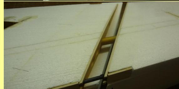
Als nächstes werden die Servoschächte angezeichnet und mit einem scharfen Bodenlegermesser aus dem Styropor herausgeschnitten. Die zuvor gefertigten Schächte aus Balsaholz werden mit PU-Kleber eingeklebt. Der Kleber bewährt sich wieder ganz toll, die Hohlräume werden perfekt ausgefüllt.
