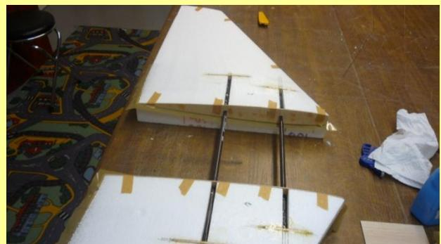
Bevor die Kohlefasersteckung eingeklebt wird, müssen noch die Wurzelrippen angezeichnet, ausgesägt und angepasst werden. Nun
