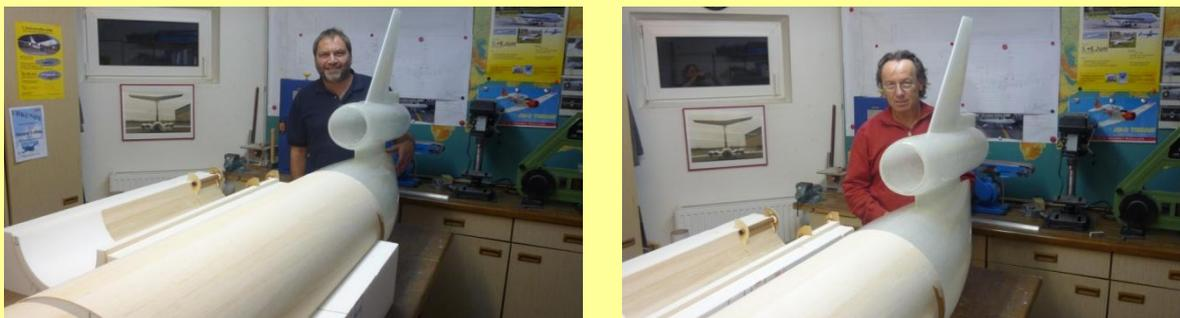
Jetzt kümmern wir uns wieder um unsere Tragflächen. Diese werden nach der gleichen Methode beplankt wie die Rumpfröhren. Davor müssen noch die elektrischen Leitungen für die Servos und Antikollisionsbeleuchtung eingebaut werden. Die Kabelschächte werden mit einem heißen U-Draht ausgeschnitten.
