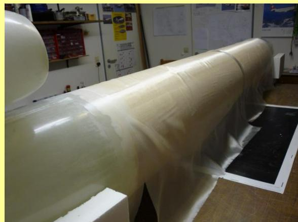
In nächster Zeit ist Schleifen und Spachteln angesagt. Der Rumpf sowie die Tragflächen werden zum Aufbringen der Grundierung vorbereitet. Zum Spachteln nehmen wir den 2K-Autospachtel, dieser ist in ca. 5 Minuten verarbeitbar und nach einer halben Stunde schleifbar.
