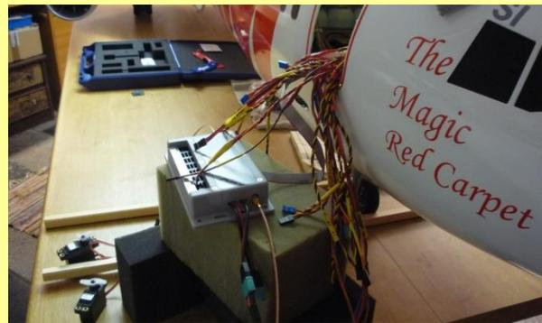
Jetzt ist alles programmiert, der Empfänger wird in die Rumpfspitze in die schon im Rohbau vorbereitete Halterung aus Sperrholz eingeschoben und mit Kunststoffschrauben gesichert. Ebenso schrauben wir die Turbine, diese ist eine Jetcat 160SX, ins Heck, die Hartholzhalterungen wurden auch schon im Rohbau eingebaut.
