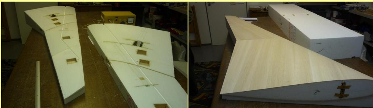
Die überstehende Balsabeplanung wird auf Kerngröße abgeschnitten, danach die Vierkant-Balsaleisten mit geeignetem Kontaktkleber ankleben und auf das vorgegebene Profil zurechthobeln und zuschleifen.
