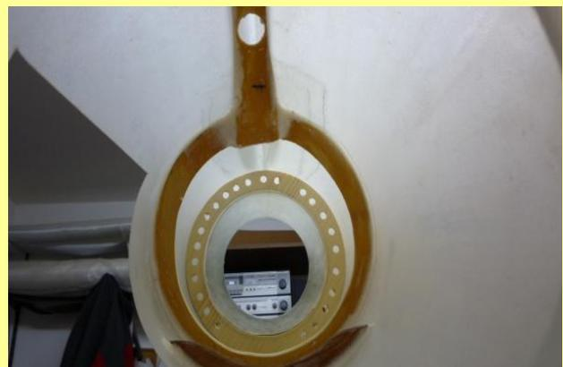
Auch die Röhren für das Höhenleitwerk sowie die Turbinenhalterung werden mit eingedicktem Harz und Gewebe befestigt.
