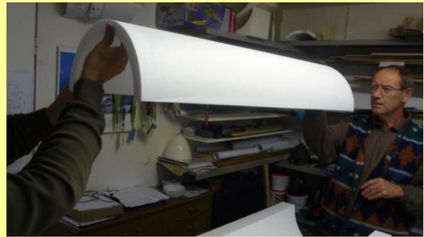
Nachdem die Kerne geschnitten sind, zeichnen wir nach langer Planung die Fahrwerke, sowie die Flächensteckung auf den Styroporkern auf. Dabei muss die Kraftverteilung beim Fliegen und Landen mit berücksichtigt werden. Es werden zusätzlich noch Spanten eingebaut.
