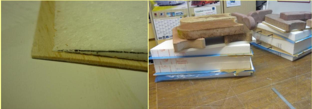
Danach sägen wir die Ruder mit der Bandsäge heraus. Balsaklötzchen zur Aufnahme der Stiftscharniere werden eingeklebt
