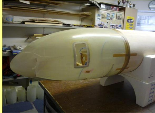
Nachdem der Kleber ausgehärtet ist, werden die Übergänge verschliffen und gespachtelt. Dieser Vorgang muss mehrmals wiederholt werden, nur so wird ein sauberer Übergang erreicht.
