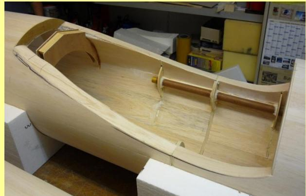
Beim nächsten Schritt geht es um die Spanten und Befestigungsbrettchen in der Rumpfspitze und Heckteil. Bei dieser Maschine muss alles was möglich ist, ganz vorne in die Spitze eingebaut werden, da die Turbine hinten eingebaut wird.
