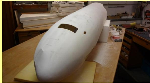
Nach mehreren Tagen sind wir so weit, die Ruder werden angeschlagen, und der Vogel kann komplett zusammengebaut werden. Doch zum Lackieren wird alles wieder auseinanderggebaut.
