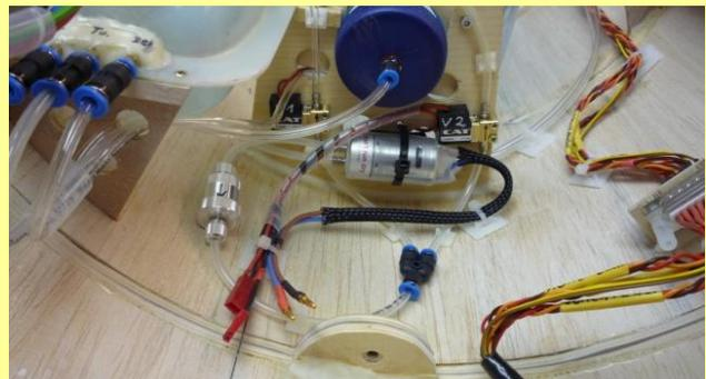
Als Tank dient eine ausgediente Wasserflasche mit einem Fassungsvermögen von 5000ml. Der reichliche Kerosinvorrat sollte für einen 15-Minuten-Flug mit ausreichend Reserve reichen. Um die Kraftstoffversorgung im Flug sicher zu stellen, bauen wir einen Hoppertank ein.
