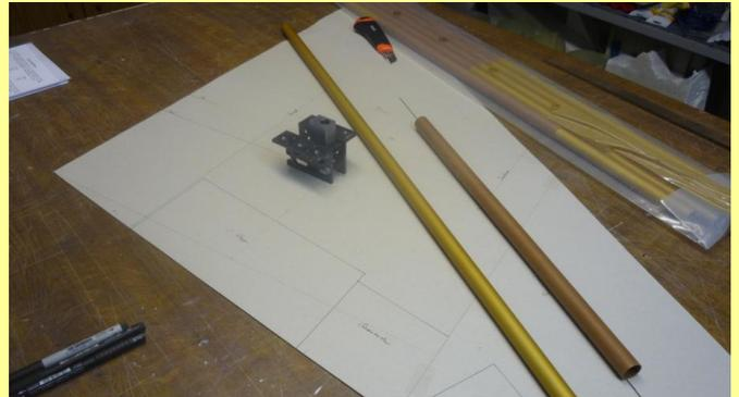
Die Form der Tragflächen, Höhen- und Seitenleitwerk, sowie des Rumpfes werden exakt im 90° Winkel herausgeschnitten. Hans Steck, Fliegerkamerad und Freund von Adi hilft uns bei den Schneidarbeiten.
