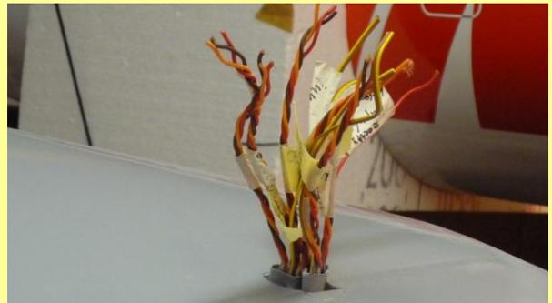
Auch die Kabel werden in den Rumpf eingezogen. Die elektrische Verbindungen der Rumpftrennung sowie zu den Tragflächen werden hergestellt. Hier muss mit voller Konzentration gearbeitet werden, um eine Verpolung der Pins zu vermeiden. Die Lötstellen müssen perfekt gelötet sein. Eine kalte Lötstelle könnte im schlimmsten Falle zum Absturz führen.
