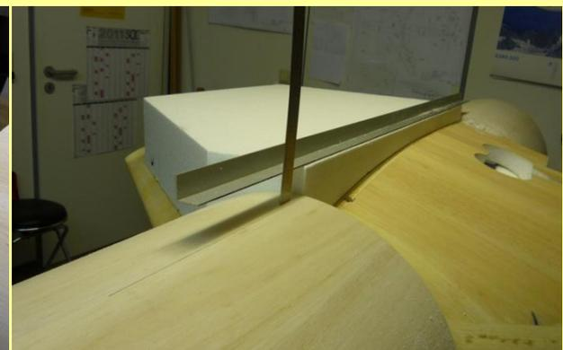
Die Spanten an der Nasen- und Endleiste werden eingeleimt, auch die Halterung für die Flächenbefestigung wird angepasst und verleimt.
